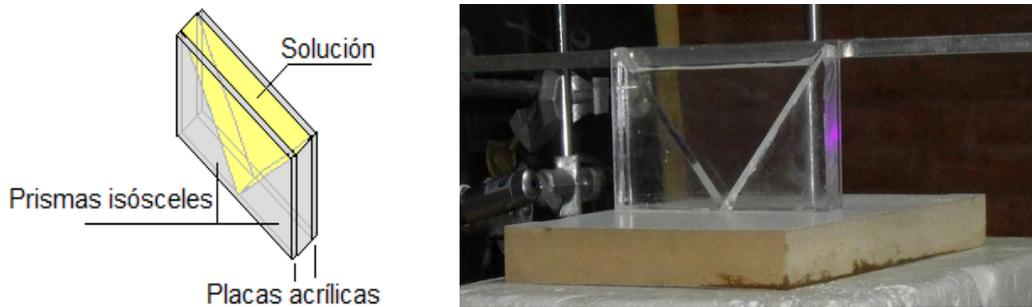
Figura 1. Esquema y fotografía de la disposición de los prismas que componen el refractómetro.
